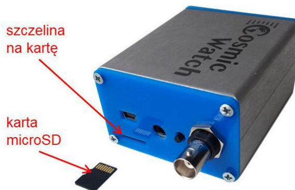
Rys. 5. Widok na tylną ściankę Licznika CosmicWatch (wersja druga Licznika).
