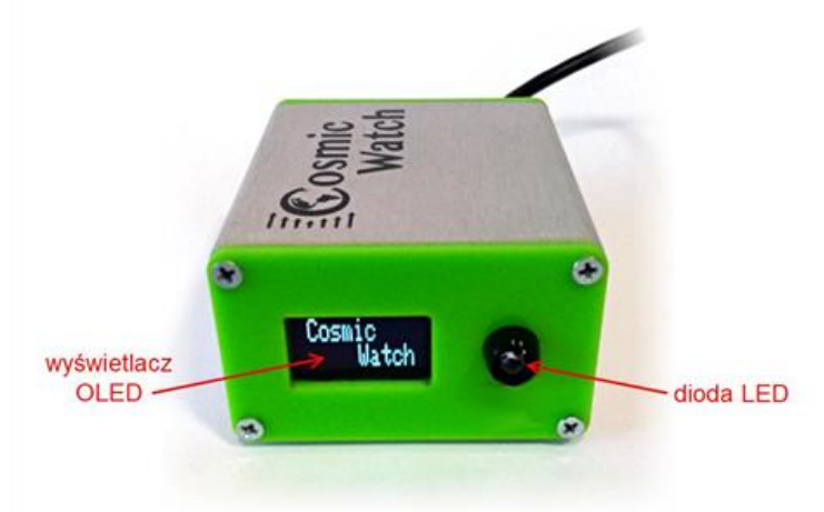
Rys. 2. Widok ścianki przedniej licznika CosmicWatch.
