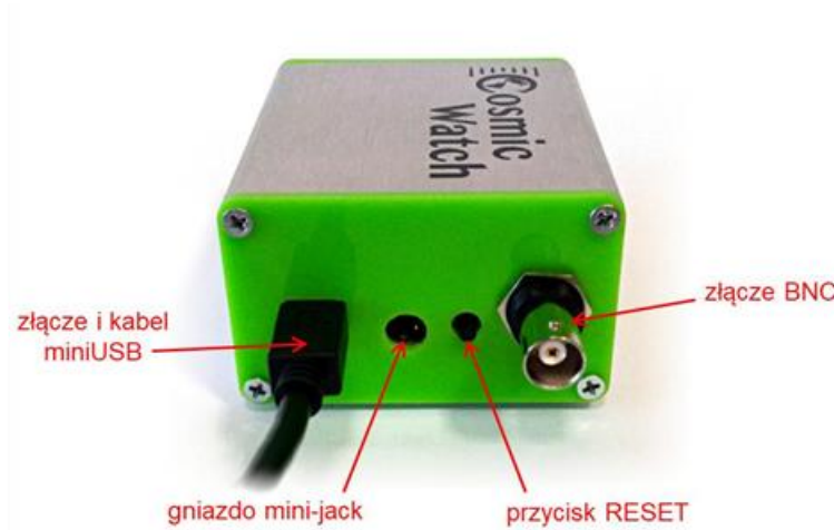
Rys. 2. Widok ścianki przedniej licznika CosmicWatch.
