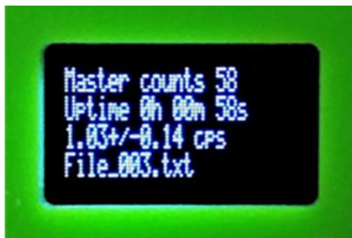
Rys. 7. Przykładowy widok wyświetlacza licznika CosmicWatch w czasie trwania pomiaru.
