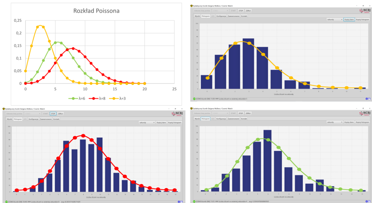
Rys. 18. Przykładowe histogramy otrzymane podczas mierzenia różnych promieniotwórczych eksponatów oraz kształt teoretycznej krzywej prawdopodobieństwa wynikającej z rozkładu Poissona.
