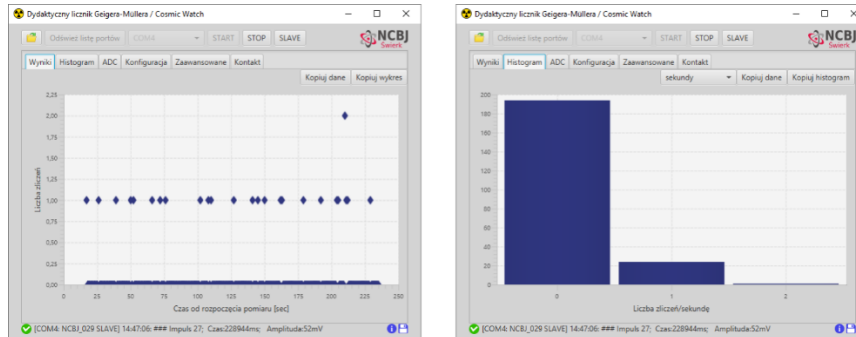
Rys. 13. Wyniki krótkiego (około 4 minutowego) pomiaru promieniowania kosmicznego w trybie SLAVE.
