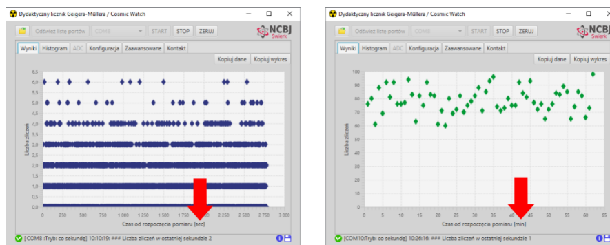
Rys. 17. Zakładka „Wyniki” dla pomiaru trwającego poniżej (po lewej stronie) i powyżej (po prawej stronie) 60 minut. W krótkich pomiarach prezentowana jest liczba impulsów na sekundę, a w długich – na minutę.
